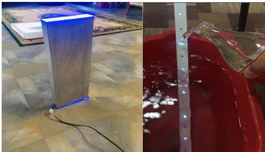
Рис.. Блок - модуль с платой с УФ-светодиодов с системой термостабилизации.
